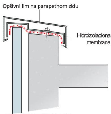
Slika 4.3.3-1 Pričvršćivanje hidroizolacione membrane
